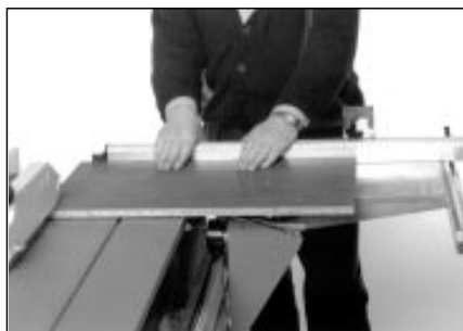
Reiter hochklappen und das Werkstück auflegen. Maschine starten und das Werkstück winkelig schneiden.
